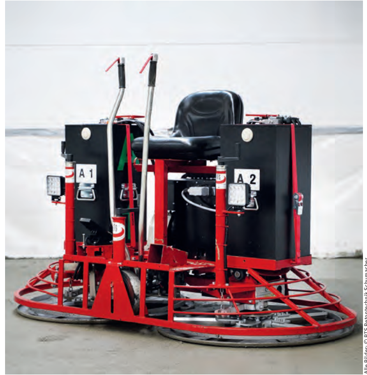
Der Akku-Doppelglätter A536-2 von BTS in der Produktionshalle
